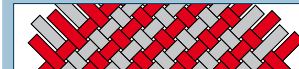
Geflochtene Schlauchhülle mit Hochleistungspolyester
