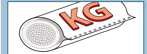
Erhabene eingewebte Tragfähigkeitsangabe
